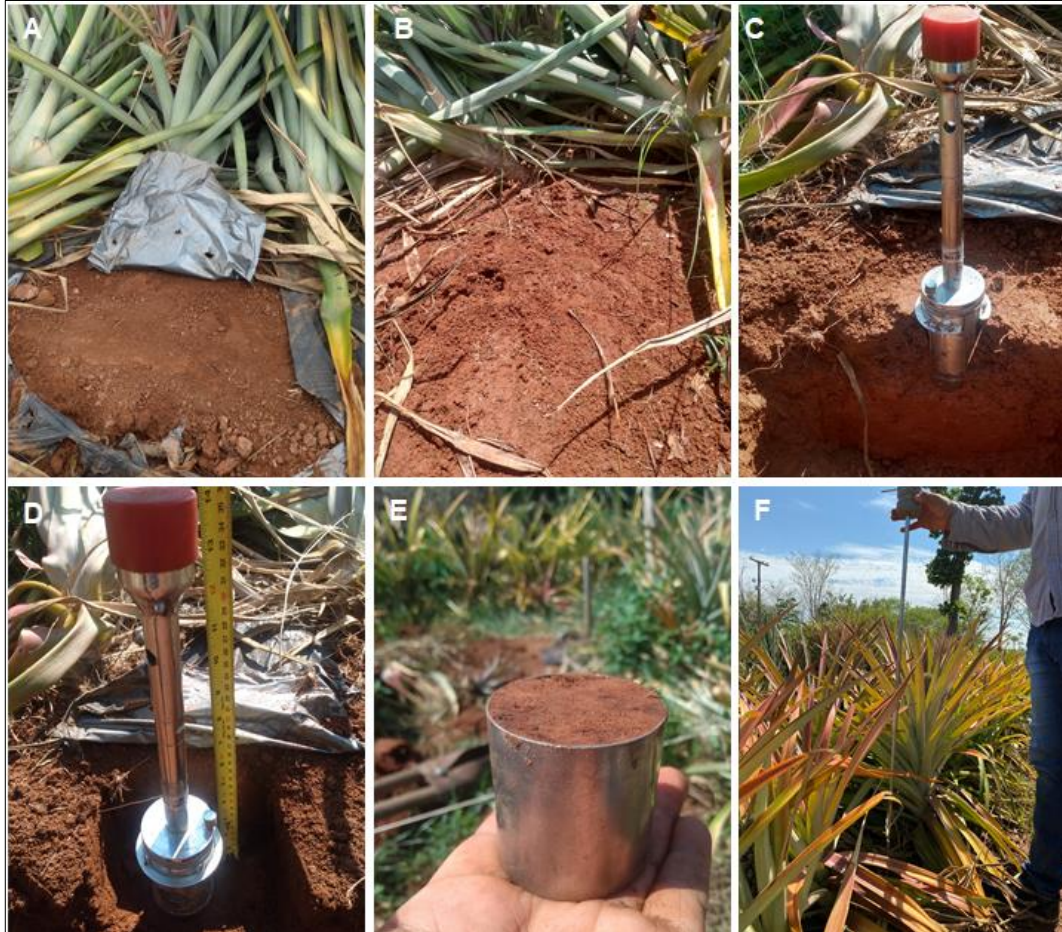
Figura 12 - Avaliação dos atributos físicos do solo nos manejos com mulching (A) e tradicional (B), com coletas, na camada de 0,0 a 0,10 m (C) 0,1 a 0,2 m do solo, de amostras com estrutura preservada (E); e avaliação da resistência mecânica a penetração (F).
