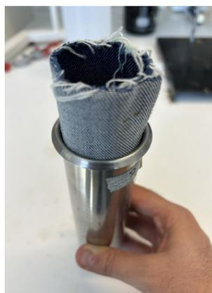
**Figura 1.** Formas de inserção do tecido denim às canecas: x) com o centro do tecido tocando o fundo da caneca e y) em formato cilíndrico, em contato com as paredes da caneca.
