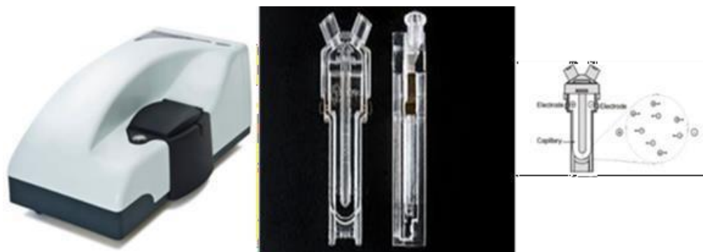
Figura 13: Equipamento e cubetas utilizados na técnica de Espalhamento Dinâmico da Luz e Potencial Zeta. À esquerda: Equipamento Malvern 3000 Zetasizer Nano ZS (Malvern Instruments Ltd., Worcestershire, Reino Unido), usado para análise de espalhamento da luz dinâmica (DLS). À direita, cubetas de vidro, utilizadas para medição da amostra.
