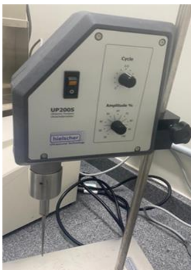
Figura 14: Imagem de um sonicador, equipamento usado para dispersão das nanopartículas em meio líquido.
