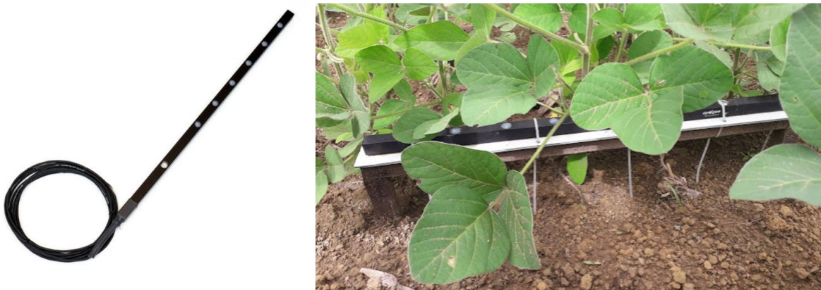
Figura 2: Sensor barra PAR Apogee® SQ-316-S instalado na linha de cultivo da cultivar 75I77 RSF IPRO (ULTRA), na área experimental da FARON, em Vilhena-RO (2018).
