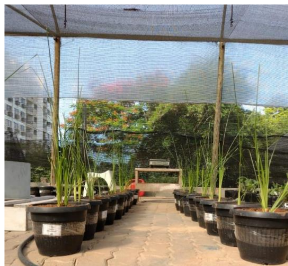
Figura 2. Capim vetiver plantado em 20 vasos com diferentes níveis de concentração de chumbo. Local: Universidade Federal Fluminense/RJ.
