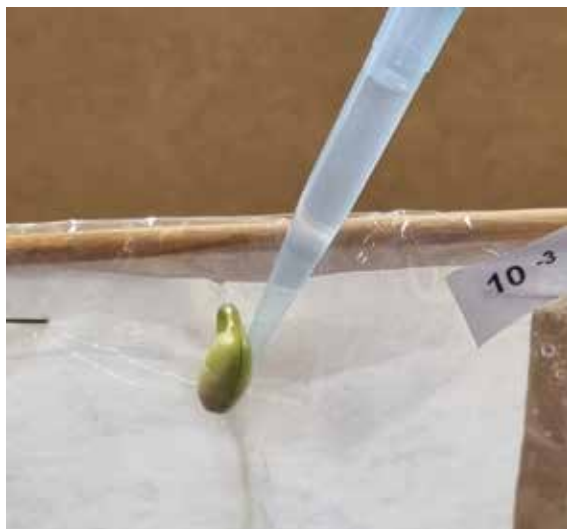
Figura 32. Transferência de 1 mL da diluição 10^{-3} de um inoculante para a região das radículas de uma plântula pré-germinada de soja, em sistema teste em saco plástico de polipropileno para análise de Número Mais Provável (NMP) de infecção de plantas.
