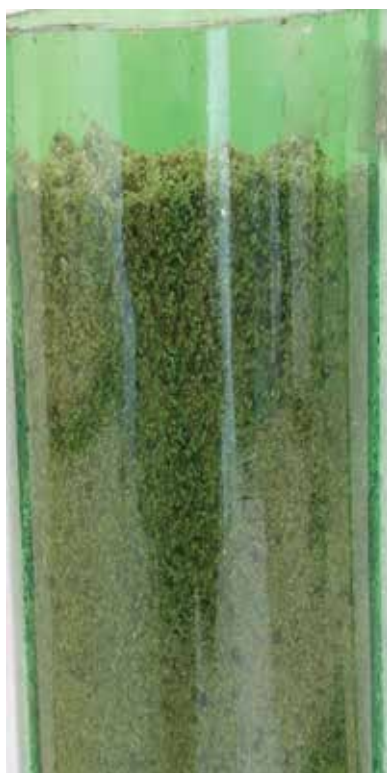
Figura 41. Suporte de plantas demonstrando a quantidade de substrato adicionada até, aproximadamente, 2 cm da borda do vaso para compor o sistema teste em vasos de Leonard para análise de Número Mais Provável (NMP) de infecção em plantas.
