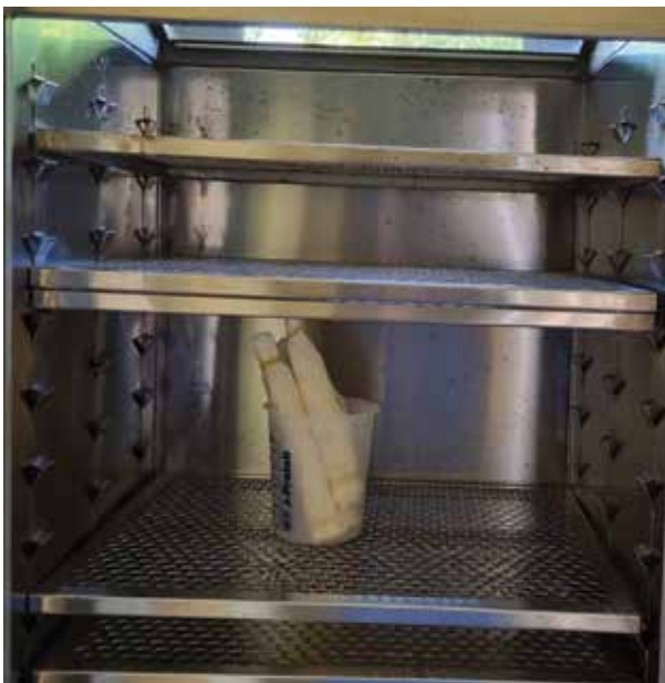
Figura 25. Sementes incubadas em germinador com temperatura controlada de 28 °C +/- 2 °C para pré-germinação para uso no teste de NMP de infecção em plantas.
