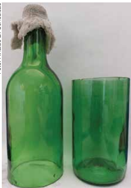
Figura 37. Garrafa de vidro cortada para a montagem do vaso de Leonard utilizado na análise de Número Mais Provável de infecção em plantas.
