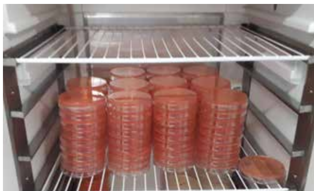
Figura 14. Placas de Petri incubadas em posição invertida em estufa de crescimento armazenadas em prateleiras.
