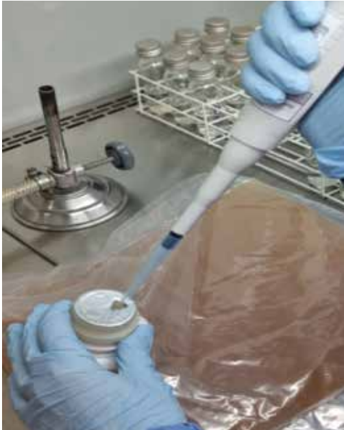
Figura 9. Aliquotagem de 1 mL de inoculante em matriz líquida em embalagem plástica.
