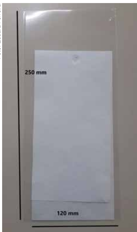
Figura 26. Saco plástico de polipropileno com as respectivas medidas, contendo em seu interior papel Germitest® com dobra e perfuração para abrigar as sementes para o teste de NMP de infecção em plantas.
