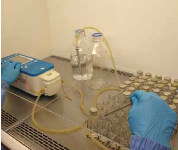
Figura 2. Distribuição de solução fisiológica (NaCl 0,85%) esterilizada em frascos de vidro esterilizados com dispensador automático de soluções.
