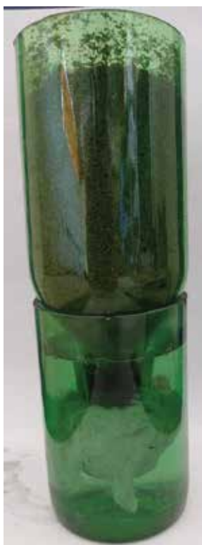
Figura 42. Sistema teste para análise do Número Mais Provável (NMP) por infecção em plantas, composto por recipientes de vidro para substrato e reservatório para solução nutritiva (vaso de Leonard) para plantas.
