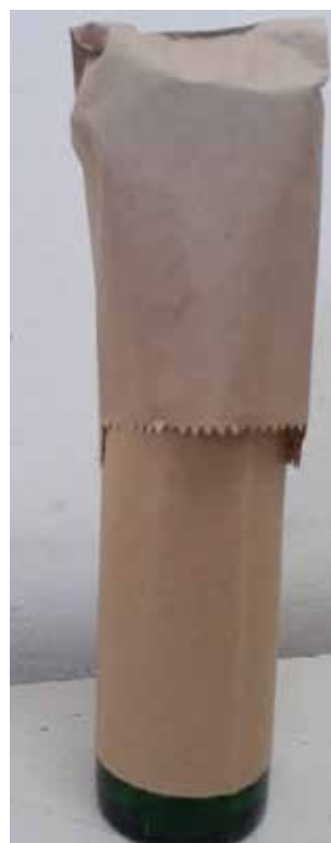
Figura 43. Sistema teste (vasos de Leonard) protegido com papel para esterilização em autoclave.
