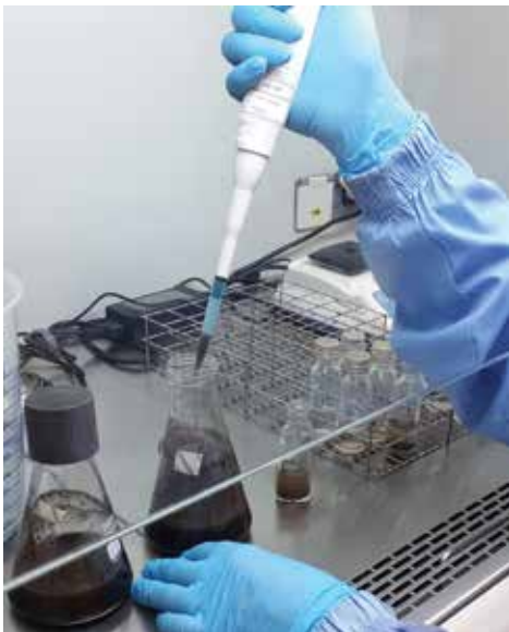
Figura 8. Transferência, em câmara de fluxo laminar, da alíquota de 1 mL da diluição 10^{-1} do inoculante turfoso para frasco com 9 mL de solução fisiológica (NaCl 0,85%), formando a diluição 10^{-2} .
