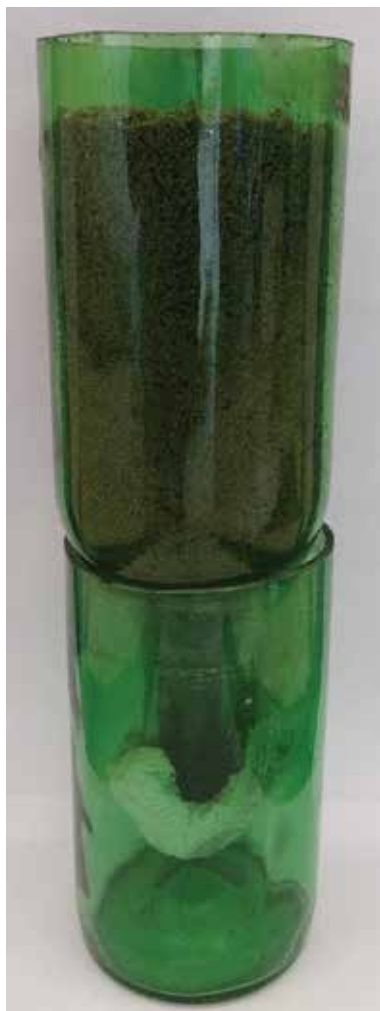
Figura 38. Sistema teste em vasos de Leonard para análise de Número Mais Provável (NMP) de infecção em plantas composto por garrafa de vidro com reservatório para substrato e reservatório para solução nutritiva para plantas.
