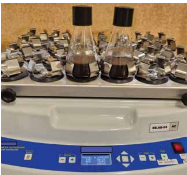
Figura 7. Mesa agitadora orbital com frascos de Erlenmeyer contendo inoculante turfoso em solução fisiológica (NaCl 0,85%).
