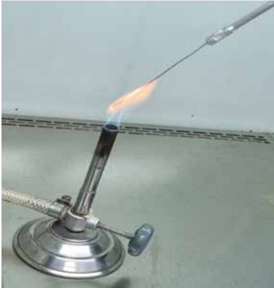
Figura 55. Flambagem da alça de platina em bico de Bunsen, levando ao aquecimento do fio de platina ao rubro.
