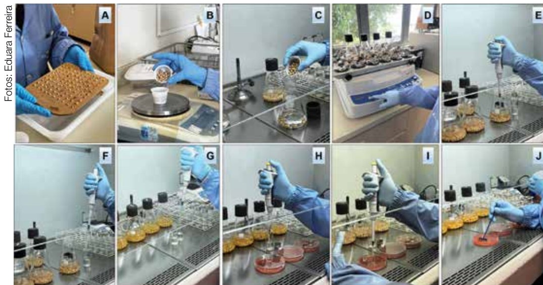
Figura 51. Etapas do ensaio de recuperação e quantificação de rizóbios em sementes inoculadas. Tabuleiro contendo 100 sementes de soja para o cálculo do peso médio (A), tomada de subamostras utilizando o peso médio de 100 sementes (B), transferência das subamostras “A”, “B” e “C” para Erlenmeyer contendo solução diluente estéril (C), agitador orbital e Erlenmeyers contendo sementes inoculadas (D), tomada de alíquota da diluição 10^0 (E), transferência da alíquota da diluição 10^0 para frasco com solução diluente estéril, obtendo-se a diluição 10^{-1} (F), transferência da alíquota da diluição 10^{-1} para frasco com solução diluente estéril, formando a diluição 10^{-2} (G), tomada de alíquota da diluição 10^{-2} para inoculação em meio de cultura (H), inoculação de 0,1 mL da alíquota da diluição 10^{-2} para placas de Petri com meio de cultura (I) e espalhamento do inóculo com alça plástica em formato T estéril, em placas de Petri contendo meio de cultura (J).
