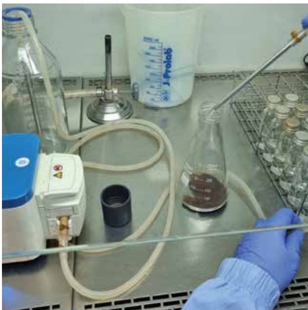
Figura 6. Distribuição de 90 mL de solução fisiológica (NaCl 0,85%) em frasco Erlenmeyer de 250 mL com 10,00 g de inoculante em matriz sólida.
