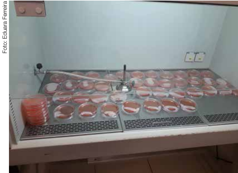
Figura AA2. Distribuição do meio de cultura YMA ( Yeast Mannitol Agar ) em placas de Petri em câmara de fluxo laminar.
