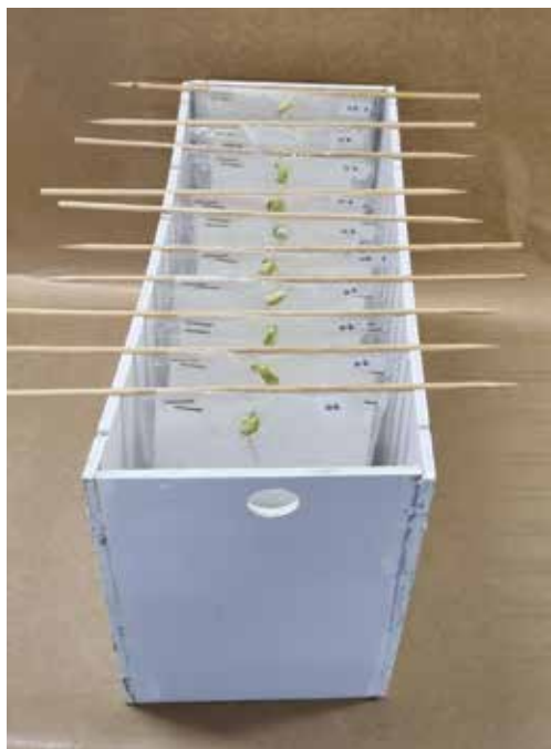
Figura 29. Suporte em madeira com unidades testes para análise de Número Mais Provável (NMP) de infecção em plantas leguminosas em sacos plásticos de polipropileno, na ilustração com sementes pré-germinadas de soja.
