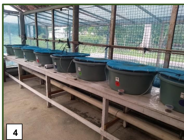
Figura 4. Bateria de caixas plásticas de 70 L (30 U.E.)
