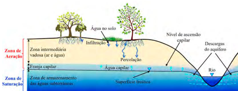
Figura 7.2. Seção esquemática mostrando as diferentes zonas do aquífero e suas relações com o rio.
