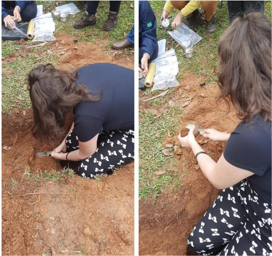
Figura 1: Coleta de amostra de solo com cilindro volumétrico.
