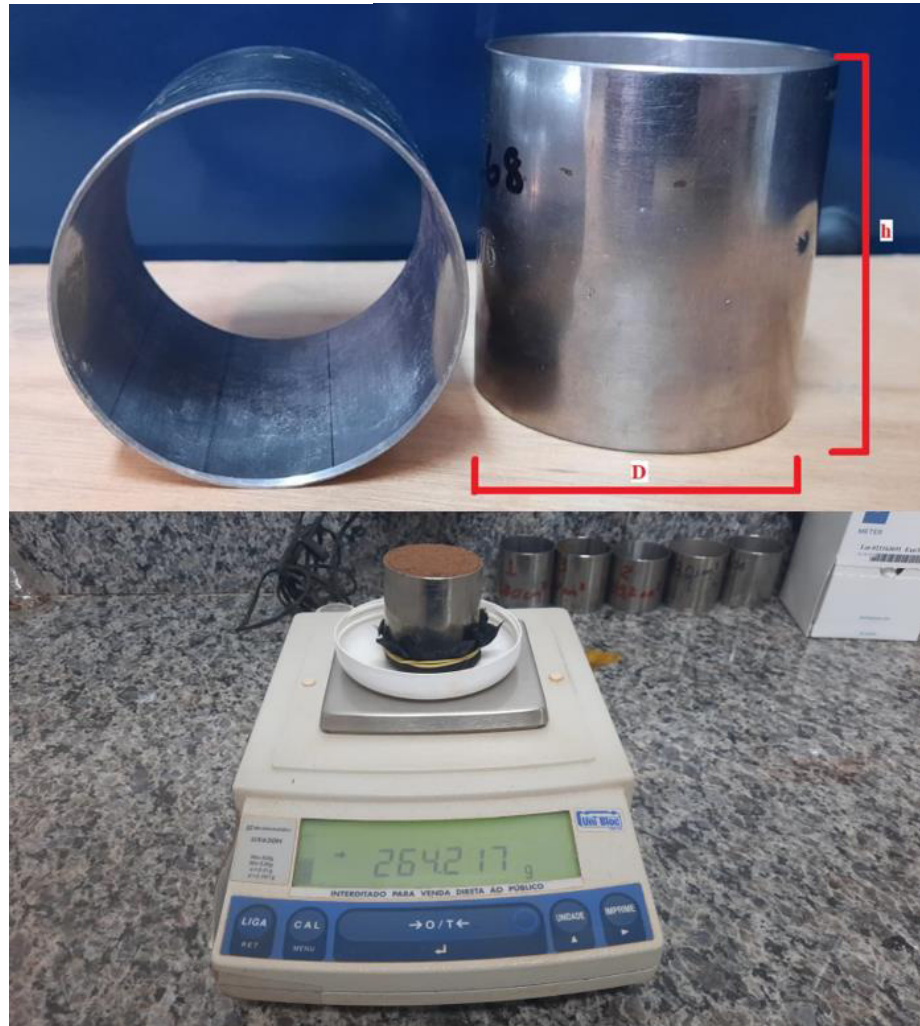
Figura 2: Método do cilindro volumétrico
