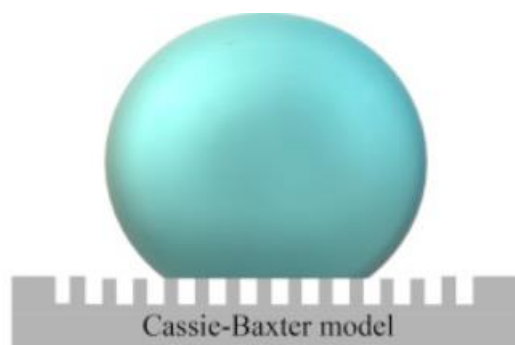
Figura 5 – Estados de molhamento de uma gota de líquido no estado de Cassie-Baxter.
