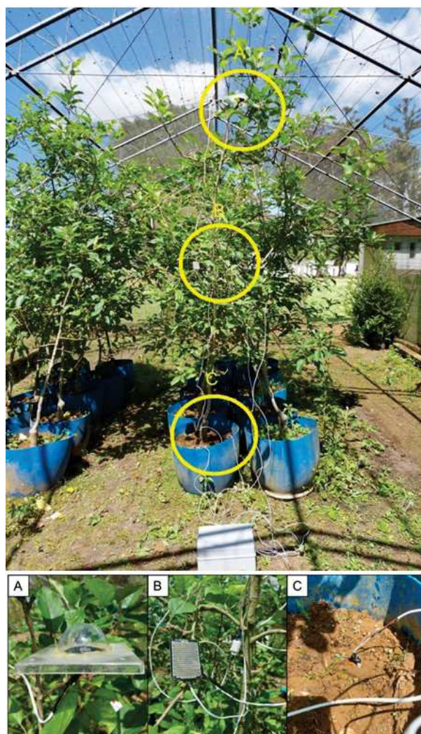
Figura 1. Instalação do equipamento e posicionamento dos sensores de luminosidade 1 (A), temperatura e umidade (B), molhamento foliar (B) e umidade do solo (C).
