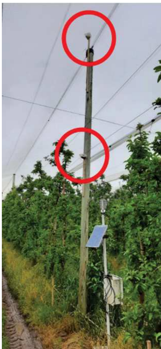
Figura 4. Montagem dos sensores de luz a campo para leituras simultâneas de luminosidade.
