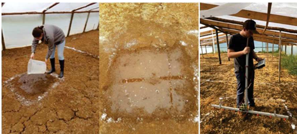
Figura 4. Processo de molhamento das áreas e medição da condutividade elétrica aparente 48 horas após o molhamento. Foto: Autores.
