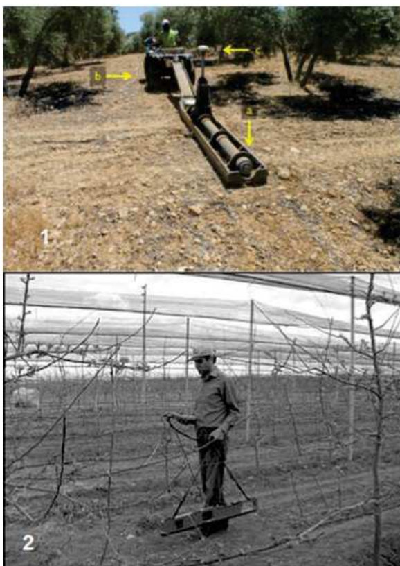
Figura 2. Equipamento de medição da condutividade elétrica aparente do solo sem contato com o solo: 1 - utilizando trenó arrastado contendo a) trenó com o sensor, b) veículo para arraste, c) antena de GPS (Pedrera-Parrilla, et al., 2016); 2 - manejo manual em pomares estabelecidos (Türker et al., 2011).
