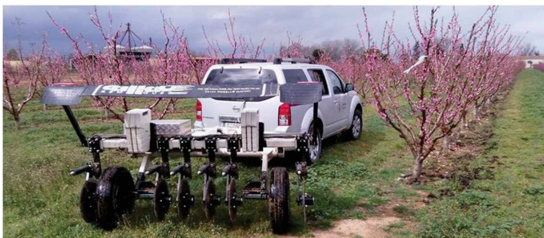
Figura 1. Equipamento comercial de medição da condutividade elétrica aparente do solo por contato. Fonte: Arnó et al., 2017.
