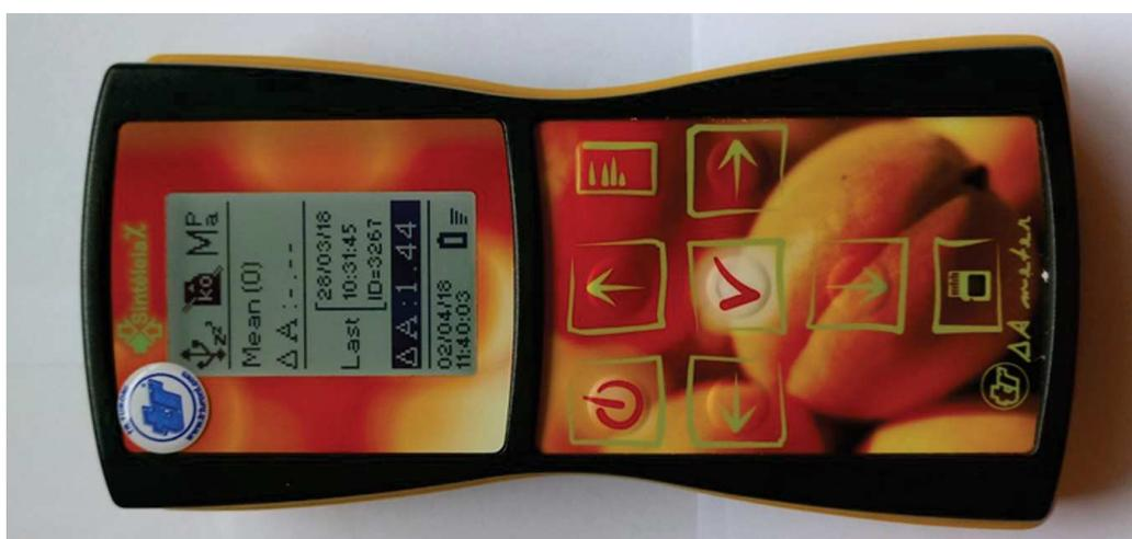
Figura 3. DA-Meter, espectrômetro portátil que mede a clorofila 'a' na casca e na polpa do fruto, e fornece um índice de diferença entre as absorvâncias ( $I_{DA}$ ) obtidas a 670 nm e a 720 nm.
