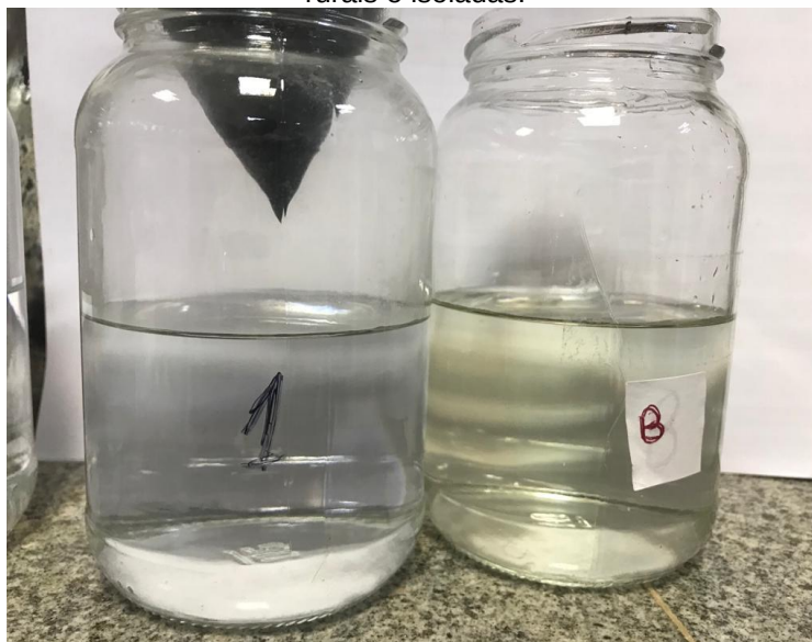
Figura 2 – Exemplo de efluente após ensaio de adsorção realizado com doses de CAEM (à esquerda - A) e do efluente sem tratamento com este produto (à direita – B). realizado com efluente final de protótipo de ETE descentralizada com vistas ao atendimento a comunidades rurais e isoladas.
