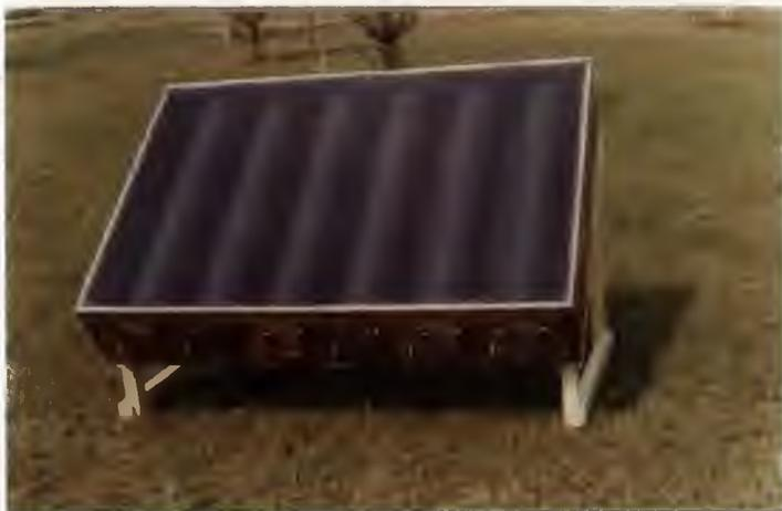
**Figura 3.** Coletor solar utilizado para a desinfestação de substrato, modelo Embrapa Meio Ambiente.
