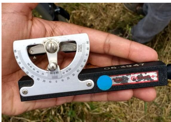
Figura 11: Clinômetro utilizado na medição da declividade da encosta dos morros.
