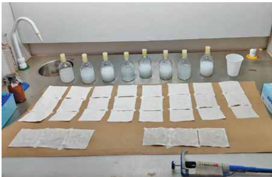
Figura 2. Diluição de acaricida e impregnação em papel filtro para o TPL.
