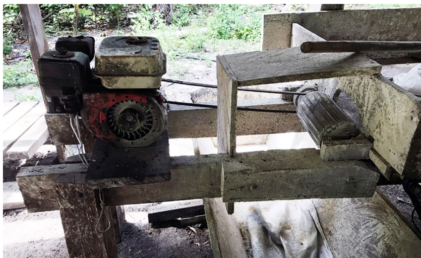
Figura 3.2. Cevadeira de raiz de mandioca ( Manihot esculenta ) (caititu), com estrutura fabricada pelo próprio agricultor, com funcionamento mecânico por intermédio de um motor a gasolina, na Vila Lagedo II, em Marabá, PA, 2019.
