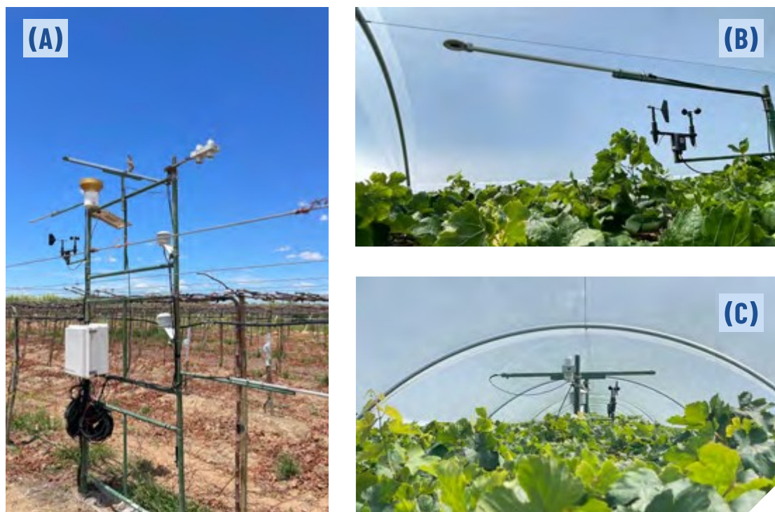
Figura 2 – Estação microclimática no interior do parreiral sem cobertura plástica (A) e sensores instalados acima da folhagem e abaixo do plástico (B e C)
