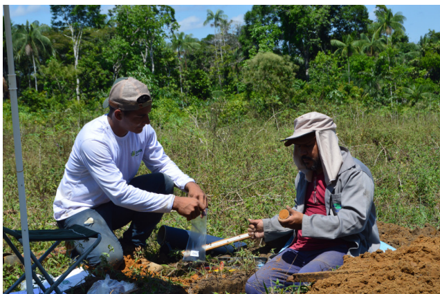
Figura 1. Coleta para determinação da densidade do solo em experimento de longa duração, Alto Pentecostes, Mâncio Lima, agosto de 2023.
