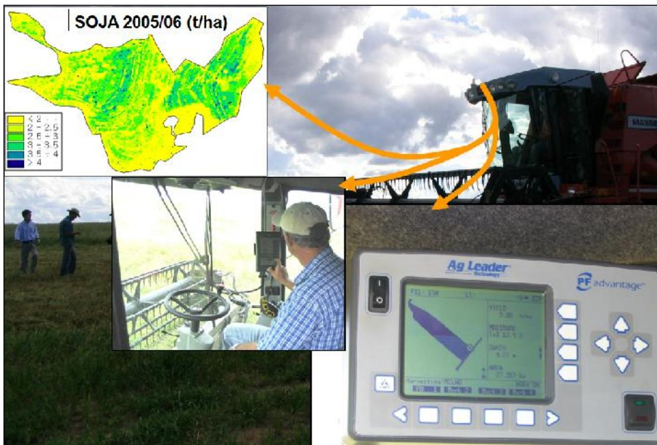
**Figura 3.** Esquema ilustrativo do mapeamento de colheita, exibindo a antena de GPS da colhedora, monitor e sistema de comando de sensores de produtividade na cabine e mapa representando os dados processados de produtividade de soja. (Fonte: Embrapa, não publicado).
