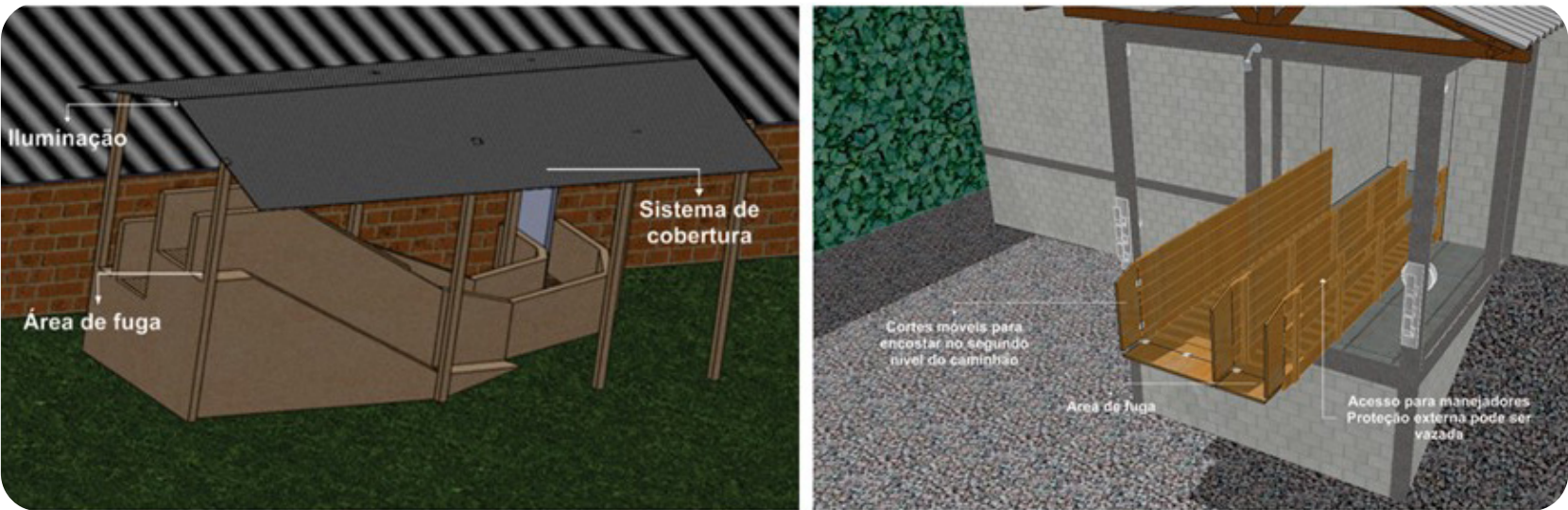
Figura 6 – O embarcadouro deve ser planejado para evitar estresse físico e facilitar a condução segura dos suínos.
