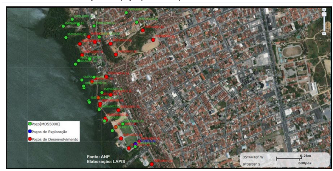
Figura 6 Conjunto de poços perfurados pela Braskem em Maceió
