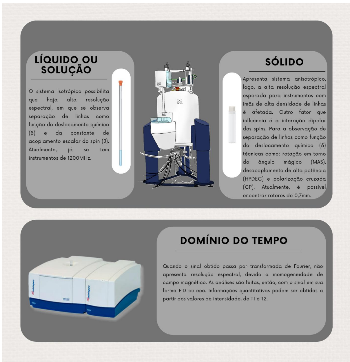
Figura 12. Espectrômetros de RMN de alto campo para amostras líquidas ou em solução e para amostras sólidas e espectrômetro de RMN no domínio do tempo.
