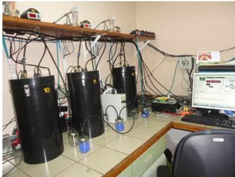
Figura 16. Biorreatores compondo o bloco (Foto: Beatriz Cordeiro).
