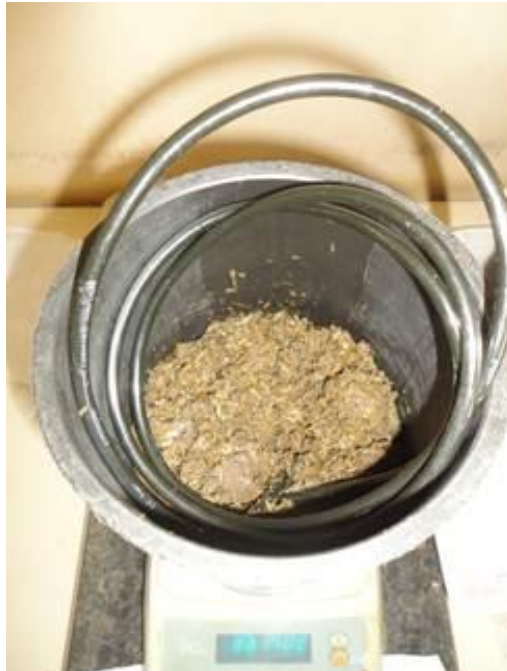
Figura 22. Biorreator 2 com Tratamento Torta de pinhão manso + esterco de cavalo (TPM + EC) (Foto: Beatriz Cordeiro).
