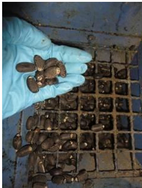
Figura 13. Sementes de pinhão manso sendo colocadas na prensa (Foto: Beatriz Cordeiro).
