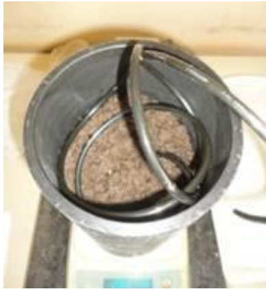
Figura 21. Biorreator 1 com o Tratamento torta de pinhão manso (TPM) sendo pesado (Foto: Beatriz Cordeiro).
