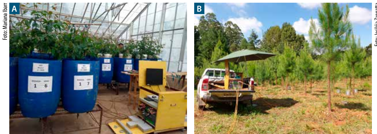
Figura 4.7. Analisador do tipo Cavity Ring-Down Spectroscopy (CRDS), em monitoramentos de fluxos de gases de efeito estufa (GEE) do solo com espécies florestais em casa de vegetação (A) e no campo (B), ambos na Embrapa Florestas.
