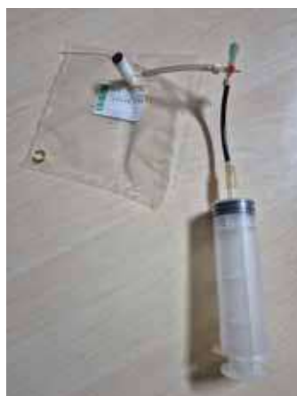
Figura 4.8. Sistema de transferência de ar da câmara para sacola Tedlar, utilizando uma seringa de 200 mL.
