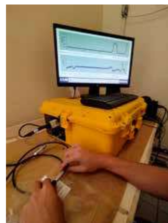
Figura 4.8. Sistema de transferência de ar da câmara para sacola Tedlar, utilizando uma seringa de 200 mL.
