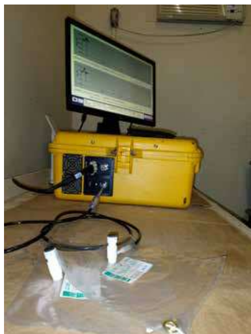
Figura 4.8. Sistema de transferência de ar da câmara para sacola Tedlar, utilizando uma seringa de 200 mL.
