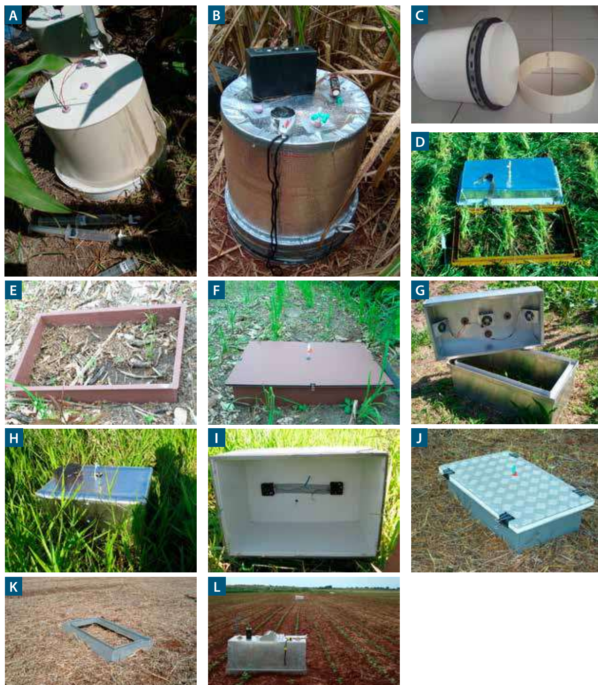
Figura 4.4. Tipos de câmaras e materiais disponíveis para a confecção: formato cilíndrico, com base em aço galvanizado e topo de PVC (A); formato cilíndrico, com base em aço galvanizado e topo de poliuretano recoberto com manta térmica (B); formato cilíndrico, com base e topo de PVC (C); formato retangular base em aço galvanizado e topo em polietileno (D); formato quadrado com base (E) e topo em aço galvanizado (F); formato retangular com base e topo em alumínio (G); formato retangular base em aço galvanizado (H); interior da câmara tipo retangular, ilustrando o posicionamento dos ventiladores na parte interna do topo (I); formato retangular base em aço galvanizado e topo em polietileno (J); formato retangular base (K) e topo em aço galvanizado (L).
