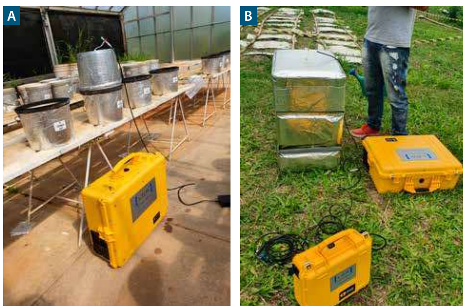
Figura 4.6. Analisador do tipo Off-Axis Integrated Cavity Output Spectroscopy (OA-ICOS) em monitoramentos de fluxos de óxido nitroso ( \text{N}_2\text{O} ) e metano ( \text{CH}_4 ) do solo plantado com soja, em casa de vegetação (A) e no campo (B), ambos na Embrapa Agrobiologia.
