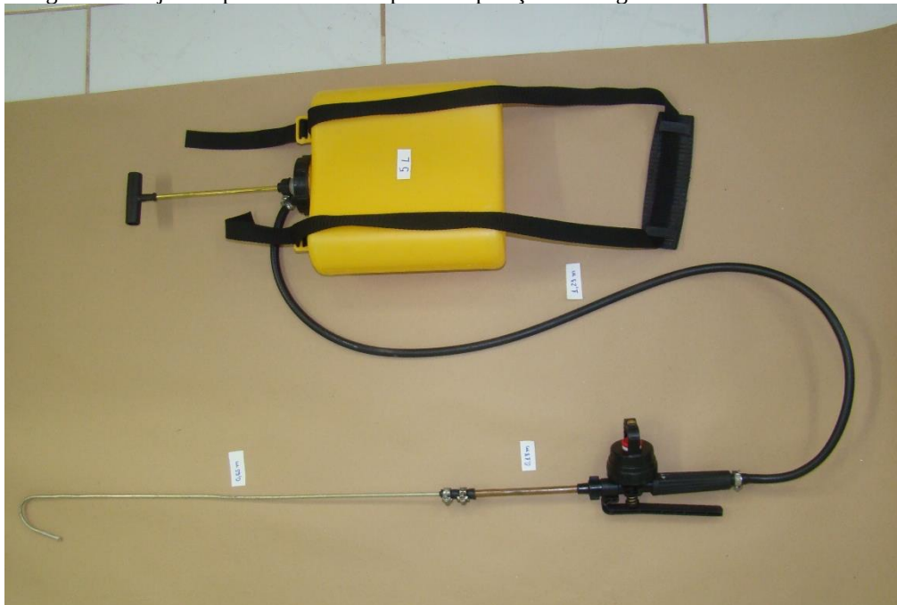
Figura 1. Conjunto aplicador-dosador para a deposição do fungicida na axila da bananeira.
