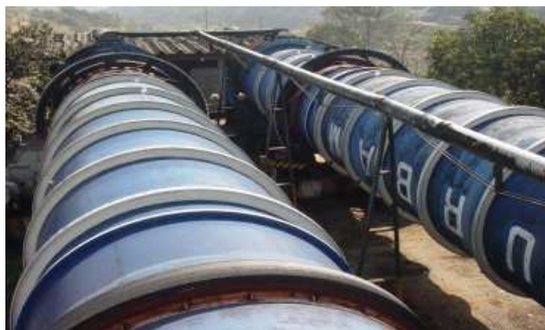
Figura 2. Sistema de produção do sistema Dano: cilindro aerador e bioestabilizador da URC (Silva et al. 2005)
