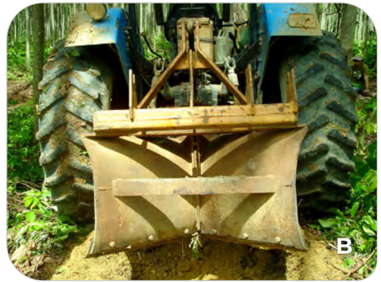
Figura 56.9. Implemento tratorizado em operação (A) e vista posterior (B) para avaliação de galerias e ninfas de Quesada gigas (Hemiptera: Cicadidae) em paricá.
