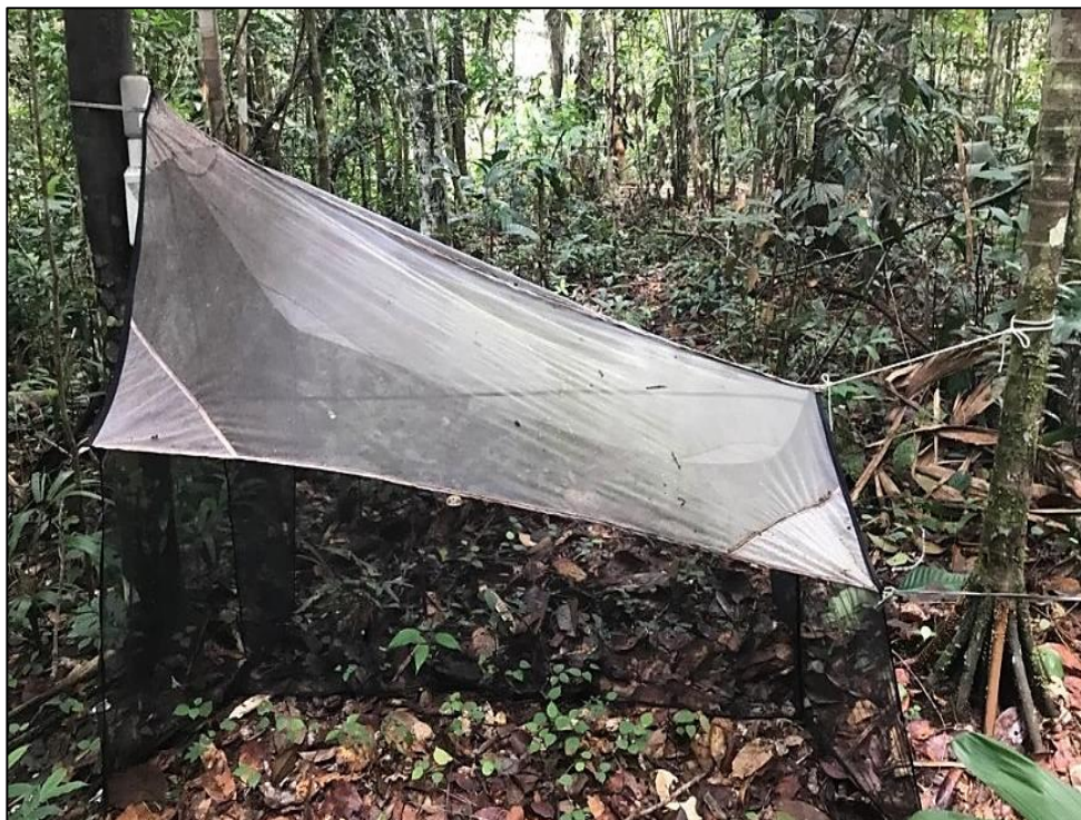
Figura 3. Armadilha Malaise instalada no interior de floresta primária na terra indígena Puyanawa, Mâncio Lima, AC. Foto: Rodrigo Souza Santos.
