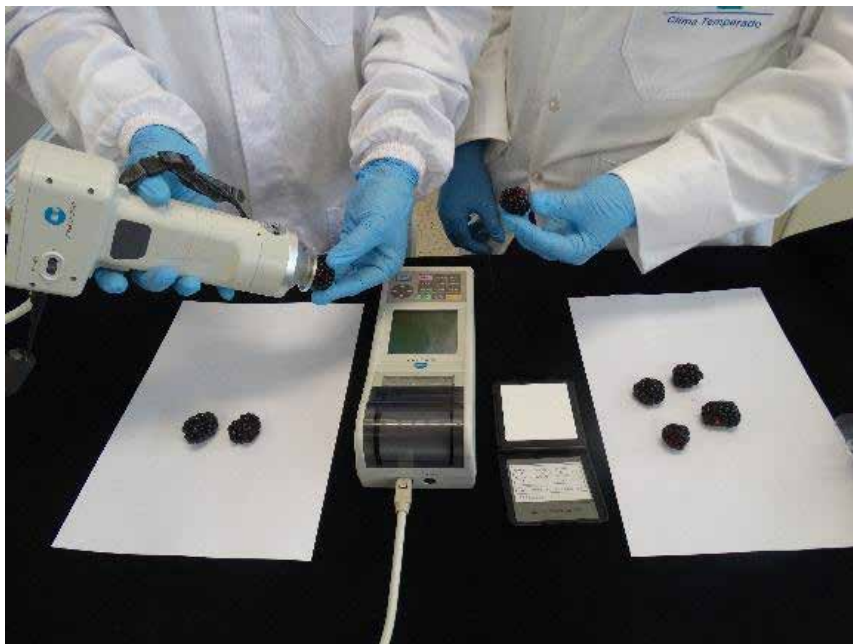
Figura 13.2. Processo de determinação da cor em amoras-pretas, utilizando colorímetro.
