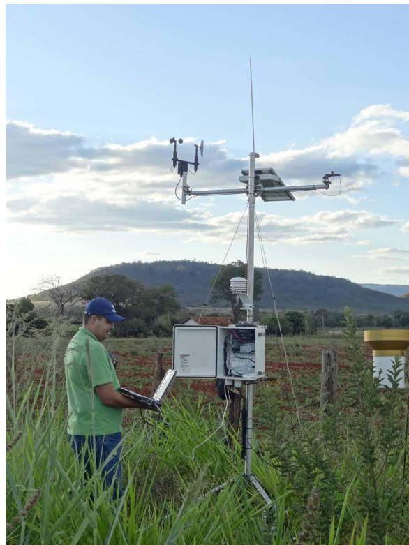
Figura 1. Estabelecimento de estratégias de manejo de irrigação a partir de determinação do requerimento de água de culturas (evapotranspiração) com registros de elementos climáticos de superfície de estações meteorológicas automáticas.
