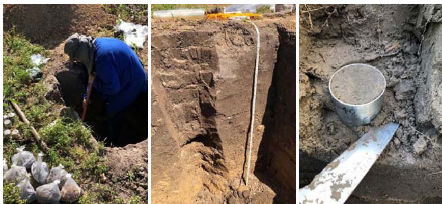
Figura 1. Método direto de amostragem de solo em campo para determinação de estoques de COS na camada de 100 cm de profundidade.
