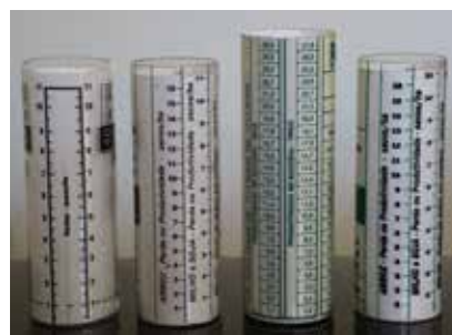
Figura 2. Diferentes designs (A) e escalas de perdas (B) do Copo Medidor de Perdas da Embrapa confeccionados no período de 1982 a 2022. Embrapa Soja, 2025.
