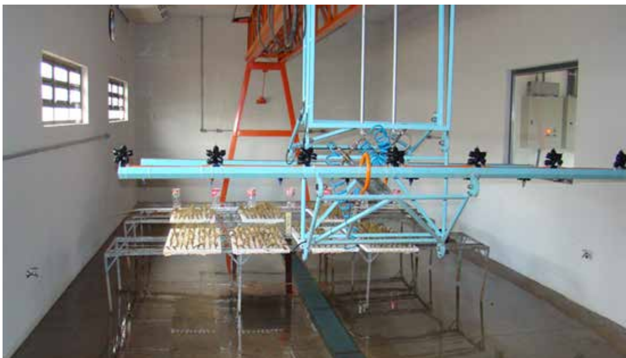
Figura 2. Simulador de chuva para avaliação da porcentagem (%) de grãos germinados em espigas colhidas previamente no campo, sendo embebidas com água durante 60 horas a temperatura entre 25°C e 30°C.
