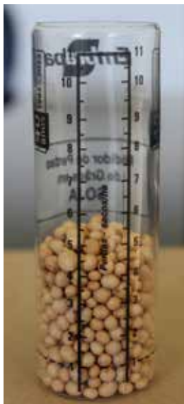
Figura 1. Detalhe real da parte de trás do Copo Medidor de Perdas da Embrapa contendo uma amostra de grãos coletada em armação de 2,0 m², indicando um valor total de perdas de 3,5 sacos de 60 kg por hectare – na imagem pode-se observar o nível aceitável de tolerância de 1,0 saco por hectare e o desperdício de 2,5 sacos por hectare que poderia ser evitado.
