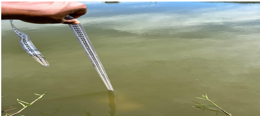
Foto da análise da transparência da água com disco de secchi, com esta simples análise é possível ter a previsão de dados de curva de oxigênio e produção primária no viveiro. Foto: COSTA. R.H.S.
