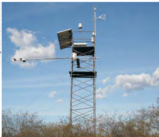
Fig. 3. Torre micrometeorológica instalada sobre a Caatinga do Semi-Árido brasileiro.
