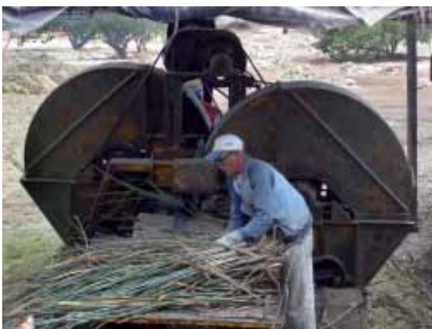
Fig. 6. Detalhe da máquina e do desfibramento do caroá.
