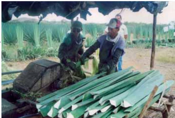
**Fig. 2.** Motor de agave para o desfibramento da folha de sisal.
