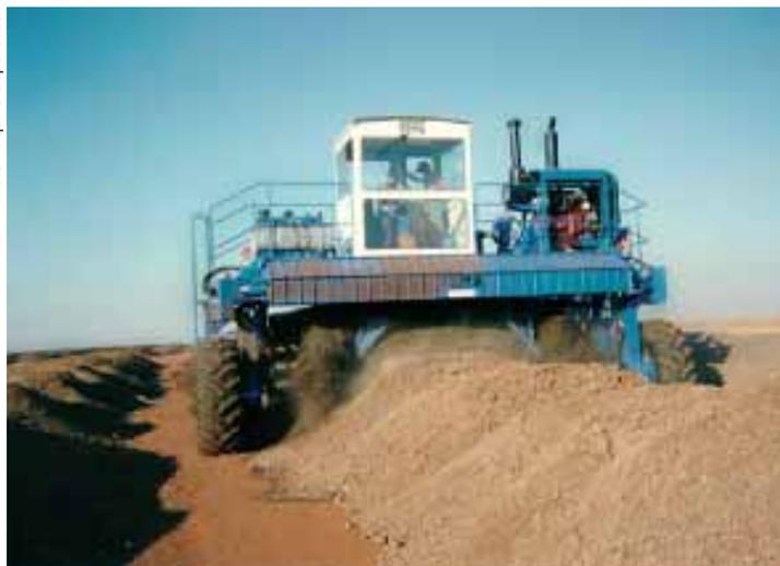
**Fig. 2.** Revolvedor de torta de filtro desenvolvido pelo Centro de Tecnologia Copersucar.
