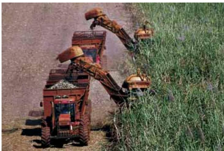
**Fig. 4.** Colheita mecanizada em canavial do Estado de São Paulo. Colhedora Case IH.
