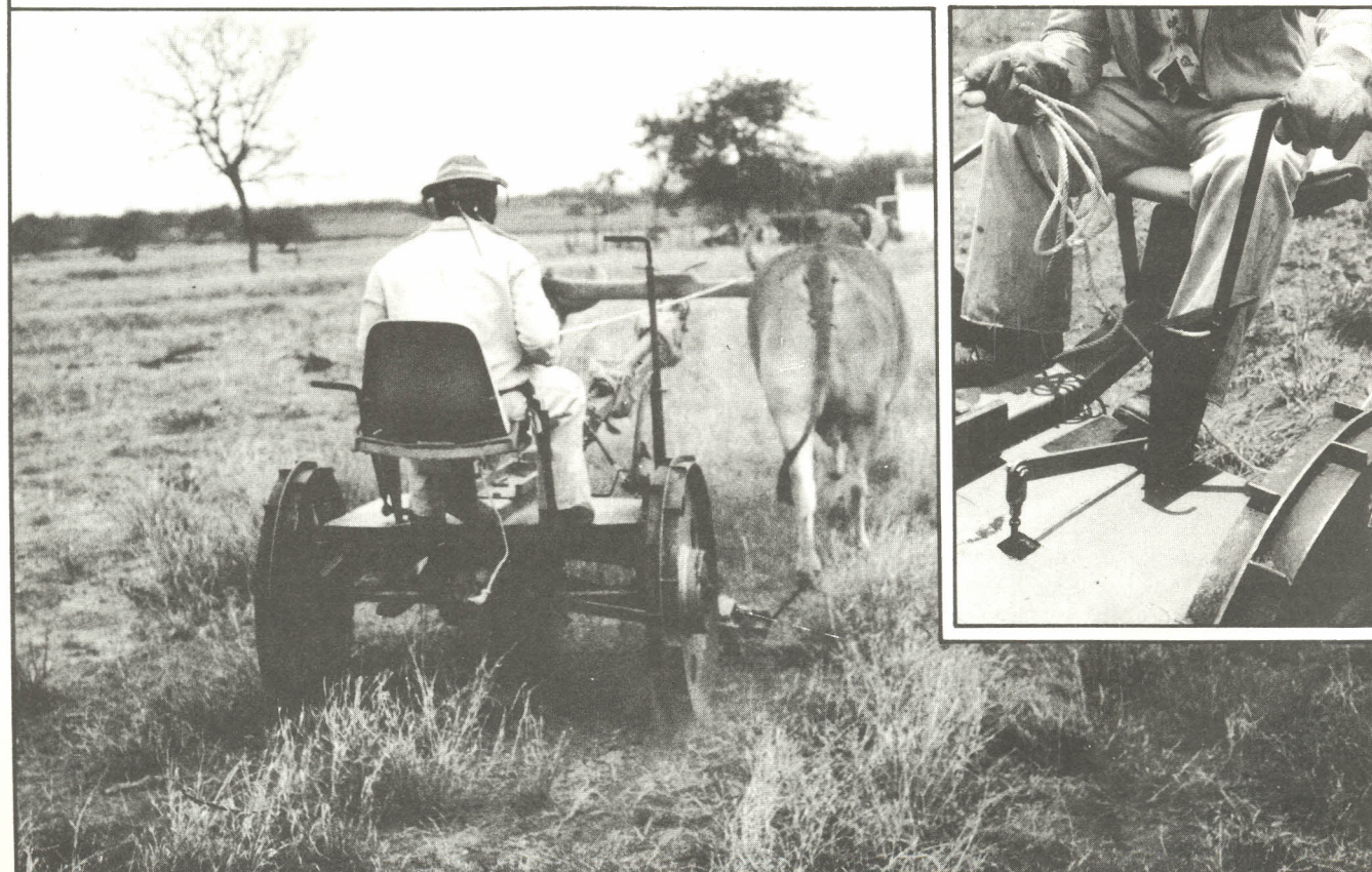
Figura 5 — Ceifadeira em operação de corte e detalhe da embreagem do sistema de transmissão.
