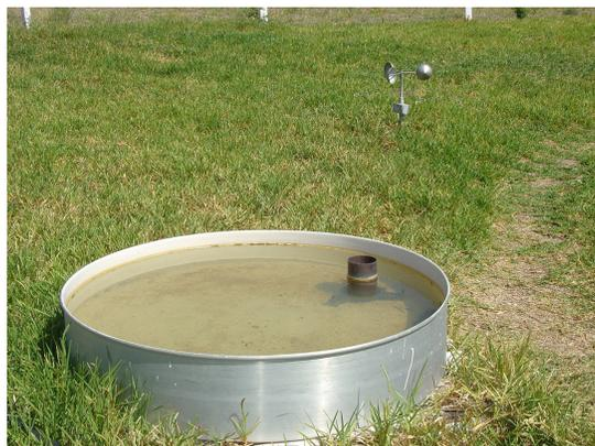
**Figura 6.** Tanque evaporimétrico Classe A com área de bordadura gramada e anemômetro
