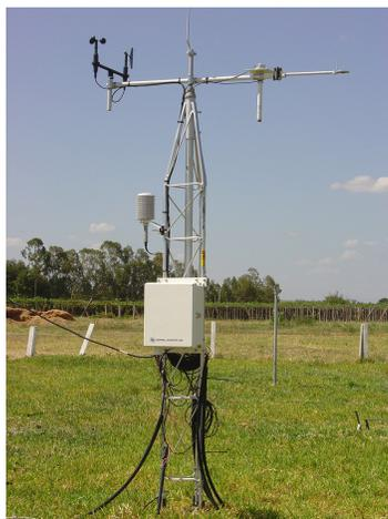
**Figura 2.** Estação Agrometeorológica Automática instalada no Campo Experimental de Bebedouro da Embrapa Semi-Árido, Petrolina-PE
