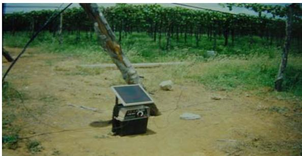
Figura 1- Eletrificador com painel solar
