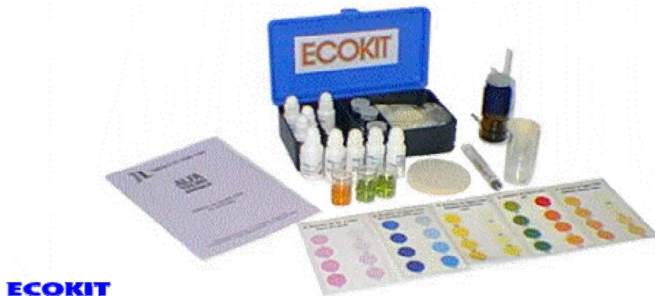
Fig. 6.5. Ecokit<sup>®</sup> para realização de análises físico-químicas da água.
