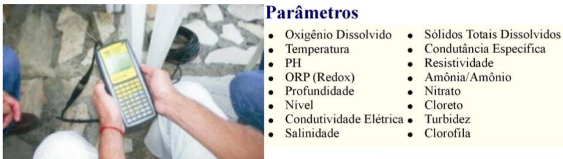
Fig. 6.10. Coletor de dados de sonda multiparâmetro.
