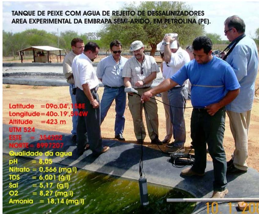
Fig. 6.9. Análise da qualidade da água utilizando a sonda multiparâmetros.
