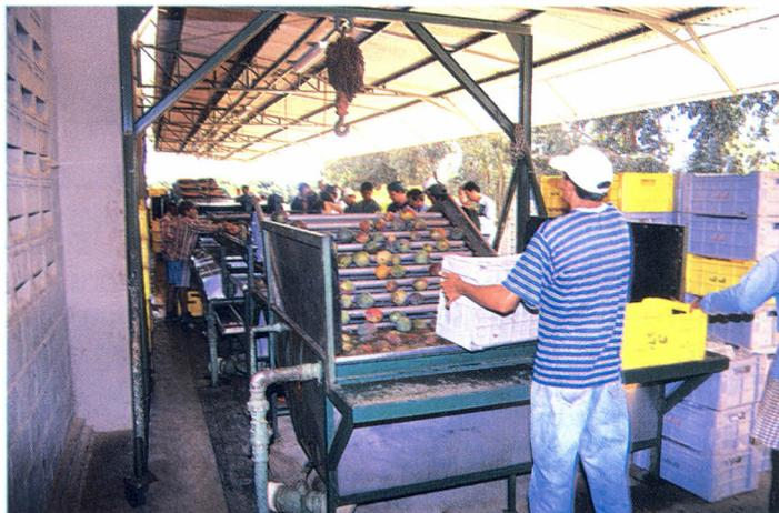
**Fig. 2.** Descarregamento da manga no tanque de recepção e lavagem.
