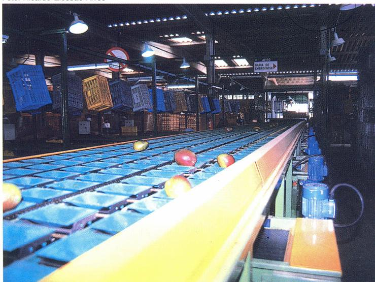
Fig. 4. Seleção mecânica por peso.
