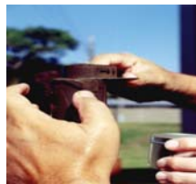
Foto 2 – Detalhe de uma sub-amostra com 2 cm de espessura do sedimento do fundo de um viveiro.
