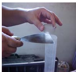
Foto 1 – Detalhe do coletor simplificado (tubo de PVC com 1,5 m de comprimento e 5 cm de diâmetro, do anel com 2 cm de espessura e da espátula para segmentar as sub-amostras de sedimento do fundo de viveiros).
