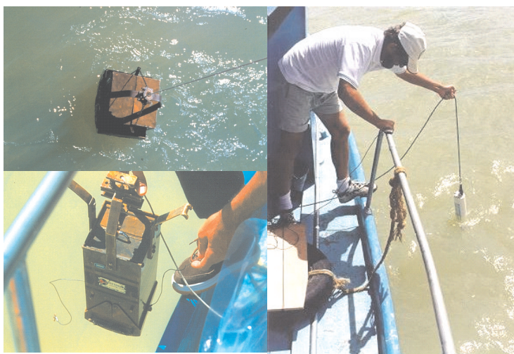
Fig. 9. Coleta de amostras de sedimentos com uma draga tipo Ekman e determinação de algumas variáveis físico-químicas de qualidade de água com uma sonda multiparâmetros.
