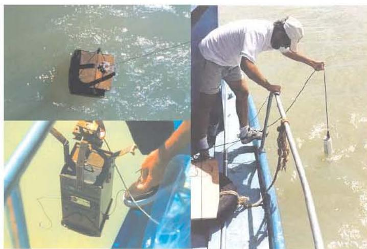
**Fig. 9.** Coleta de amostras de sedimentos com uma draga tipo Ekman e determinação de algumas variáveis físico-químicas de qualidade de água com uma sonda multiparâmetros.
