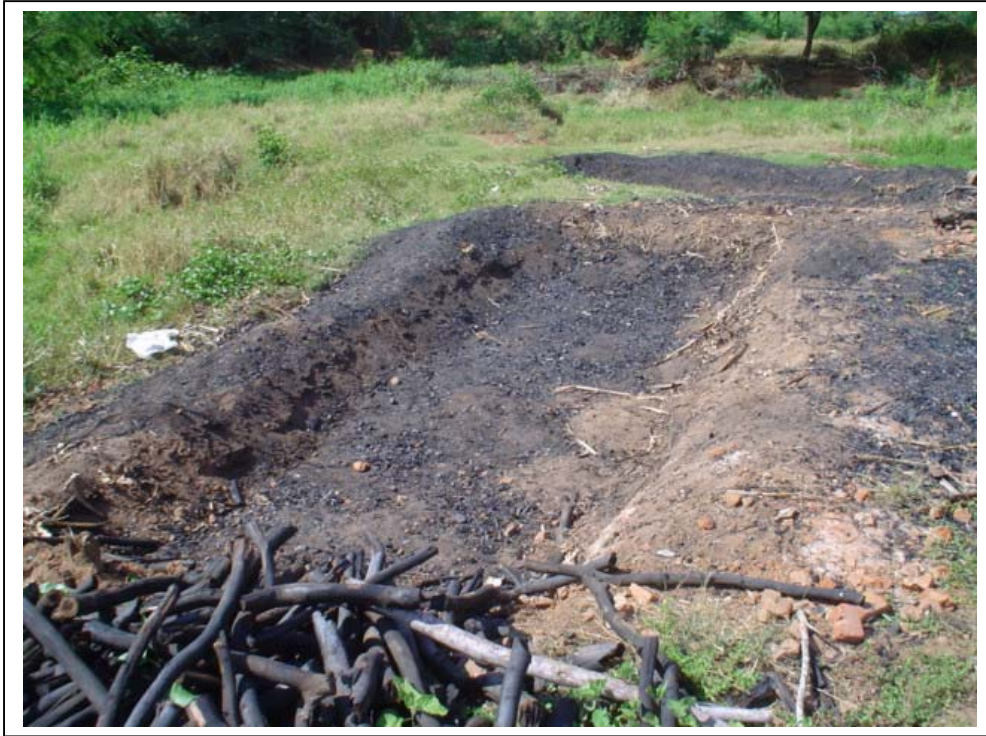
FIGURA 13 – Tipo de forno encontrado em Lagoa Grande-PE (Forno trincheira)
