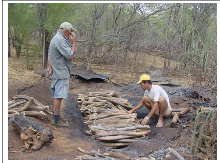
3º Passo: Arrumação final da pilha de lenha
