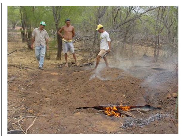
6º Passo: Cobertura com terra e acender o forno
