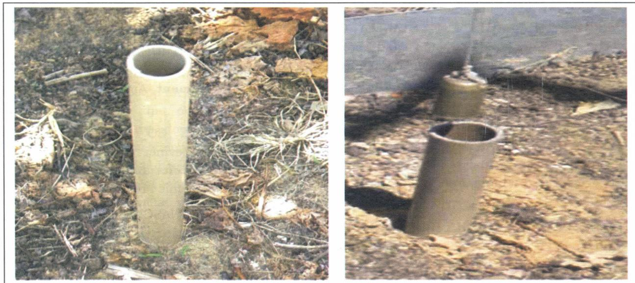
FIGURA 7. Detalhes da instalação de poços de observação e da leitura do lençol freático, Petrolina, PE.
