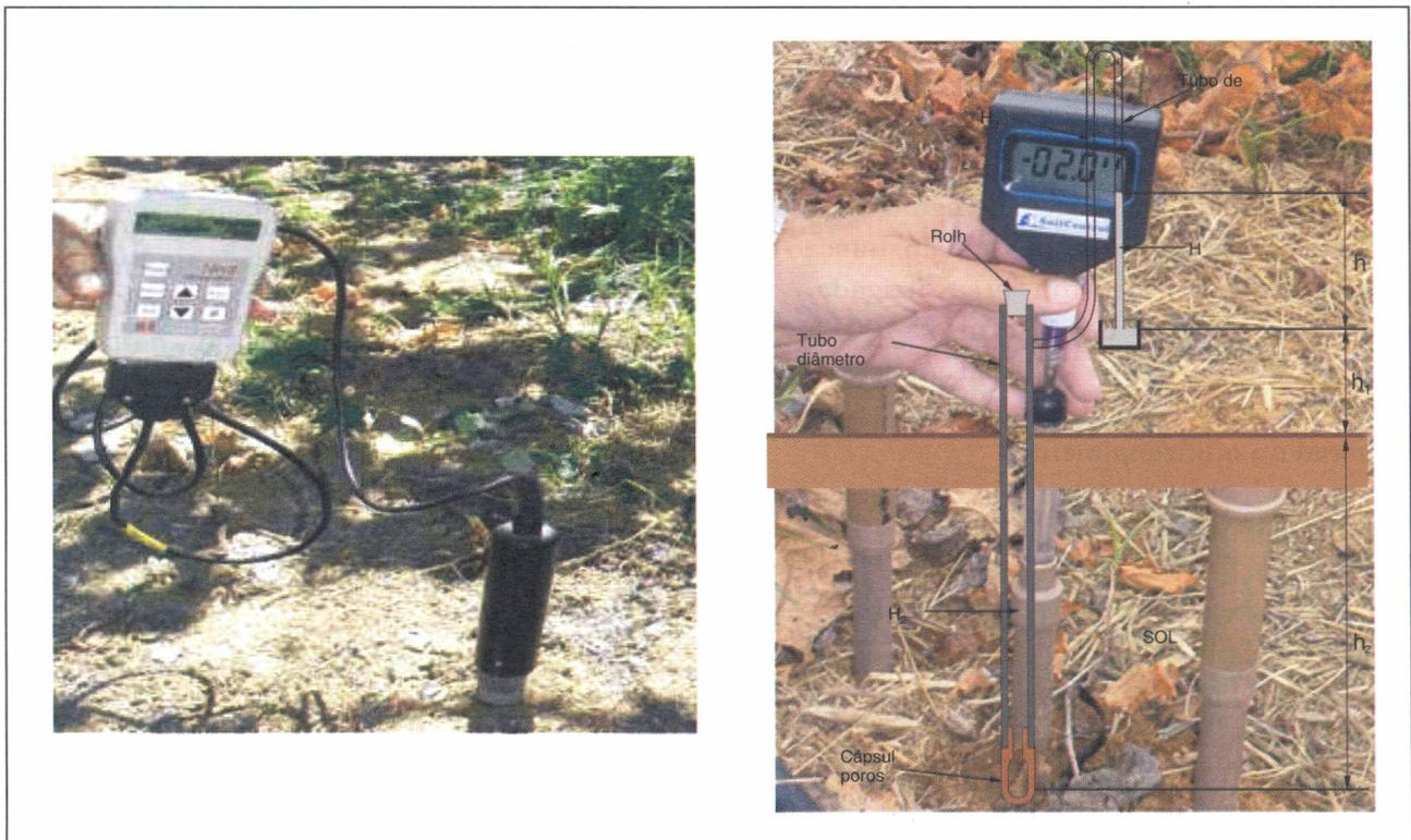
FIGURA 6. Tensiômetro de mercúrio (foto da esquerda) e tensiômetro associado com tensímetro (foto da direita), Petrolina, PE.
