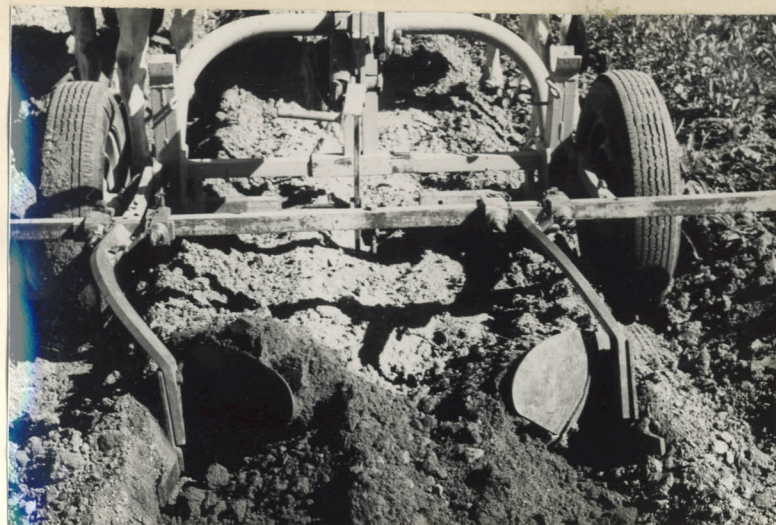
Foto 6. Arados de aiveca acoplados a barra do tropicultor
