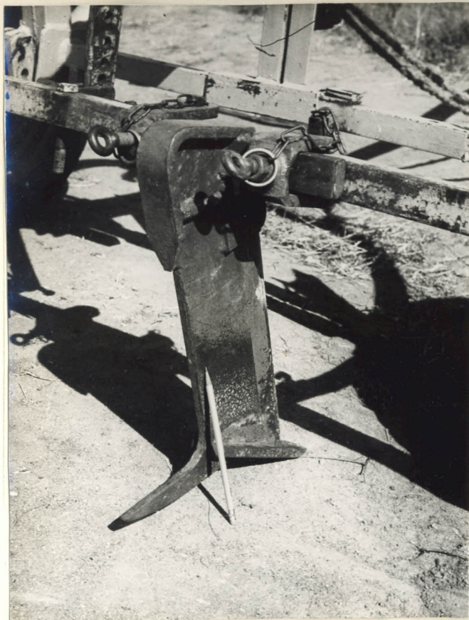
Foto 17. Detalhe de um sub-solador acoplado a barra de tra ção do tropicultor
