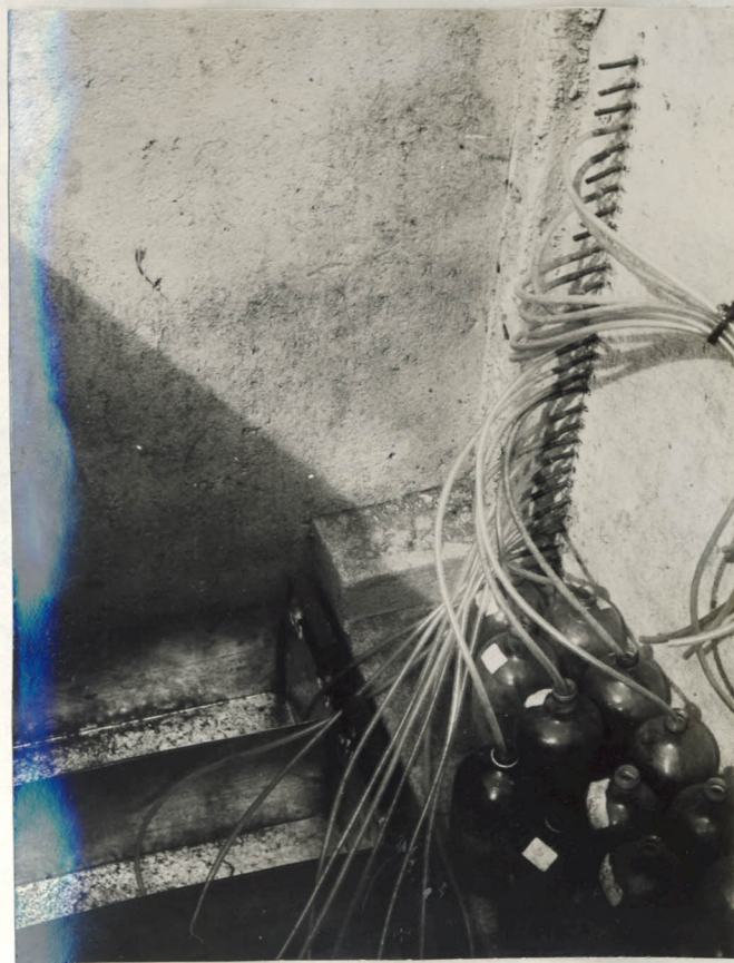
Foto 20. Coletor de sedimento com captação direta na calha Parshall (parte interna)
