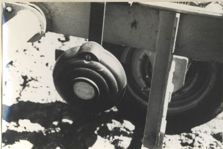
Foto 13. Registrador de tempo usado para apropriação de custo das operações
