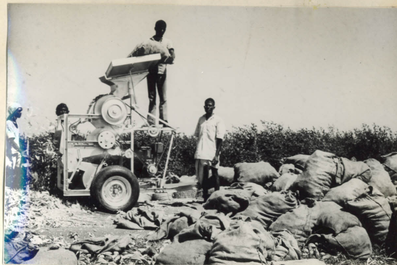
Foto 14. Debulhador de milho para parcelas experimentais
