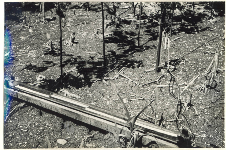
Foto 4. Detalhe de um solarímetro para determinar interceptação de luz
