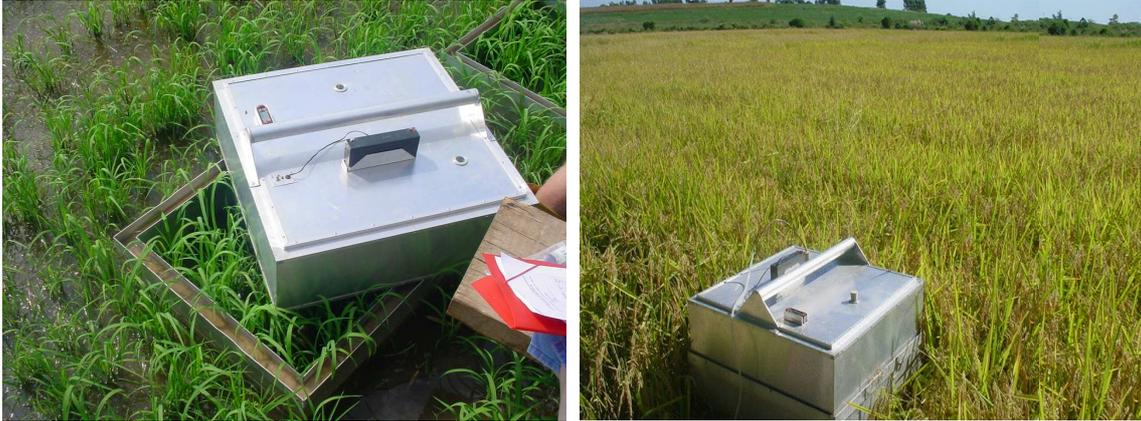
**Figura 1:** câmara coletora de gás metano, já com o topo para coleta, instalado em Santa Maria, RS na safra 2005/2006.
